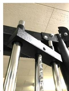
メインフレーム（１）のくぼみにウェイトガイドロッド（４５）を差し込み底の部分がズレないように斜めに傾けてウェイトスタック（４７）をキロ表記の大きい順に上部から一つずつ差し込んでください。
