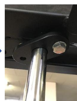
すべてのウェイトスタック（４７）差し込んだらガイドロッドプレート（４６）をウェイトガイドロッド（４５）に差し込んでトップフレーム（６）のボルト穴の穴に合わせて、ガイドロッドプレート（４６）を再度取り付けて下さい。
